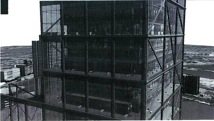
3D représentation de l'intérieur d'un bâtiment se basant sur les éléments architecturaux 'standards' composant un édifice. Une fois la modélisation d'un étage réalisé, sa répétition peut être faite de manière quasi instantanée, permettant ainsi un rendu rapide et réaliste d'un environnement construit. (Courtoisie de Procedural Ltd).
